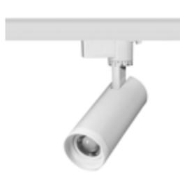
Трековый светильник однофазный; 20Вт; 1350лм; 3000К; 15-55°; Ra>80; 220-240В; ø220×70мм; белый; Пластик + Алюминий
