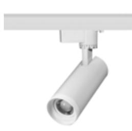
Трековый светильник однофазный; 30Вт; 2100лм; 4000К; 15-55°; Ra>80; 220-240В; ø230×80мм; белый; Пластик + Алюминий
