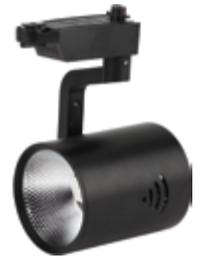
Трековый светильник однофазный; 10Вт; 2100лм; 4000К; 26°; Ra>80; 220-240В; ø100×235мм; черный; Пластик + Алюминий
