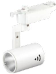
Трековый светильник однофазный; 10Вт; 700лм; 4000К; 26°; Ra>80; 220-240В; ø54×175мм; белый; Пластик + Алюминий
