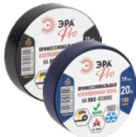
Для проведения профессиональных электромонтажных работ. За счёт негорючести ПВХ-основы имеет превосходную стойкость к электропробою и высоким температурам. Выдерживает напряжение в 6000 В. Пожаробезопасна, не поддерживает горение. Не боится также и отрицательных температур. Удлинение при разрыве 220%. Высший сорт. Соответствует требованиям ГОСТ 16214-86
