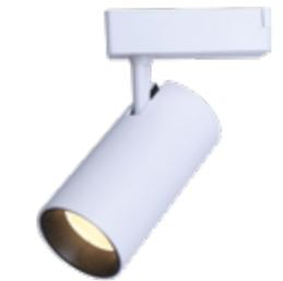
Трековый светильник однофазный; 20Вт; 1400лм; 4000К; 26°; Ra>80; 220-240В; 68×160×118мм; белый; Пластик + Алюминий
