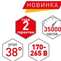
Светодиодные лампы Led Lense предназначены для использования в акцентной подсветке и трековом освещении. Отличаются узконаправленным световым пучком 38°. Идеальны для использования в трековых и точечных светильниках (см. раздел "Трековые светильники" на стр. 74 и раздел "Точечные светильники" на стр. 43). Цоколь GU5.3 и GU10
