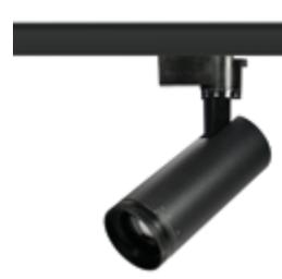
Трековый светильник однофазный; 30Вт; 2100лм; 3000К; 15-55°; Ra>80; 220-240В; ø230×80мм; черный; Пластик + Алюминий
