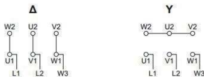
Рисунок А.1.1 - Схема подключения двигателя с соединением фаз обмотки «Δ/Υ» (шесть выводных концов).
