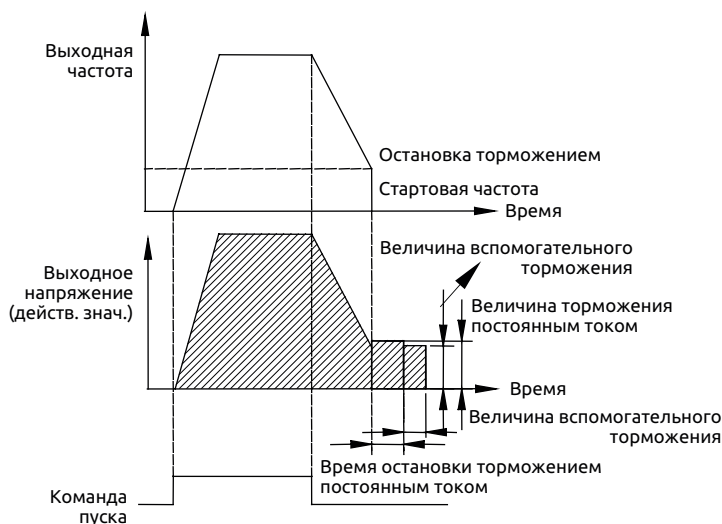
Рис. 7-5 Торможение до останова + торможение постоянным током
