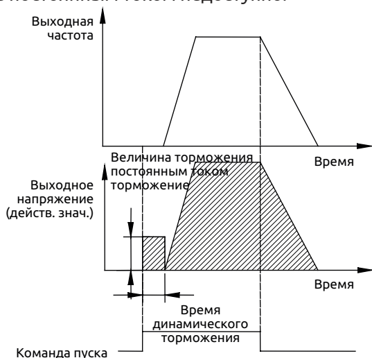
Рис. 7-4 Описание режима пуска 1, заданного кодом F02.06
