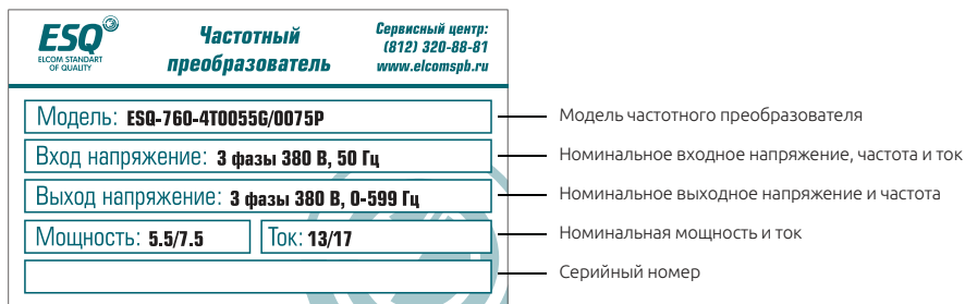
Рисунок 2-4. Изображение шильды частотного преобразователя ESQ-760
