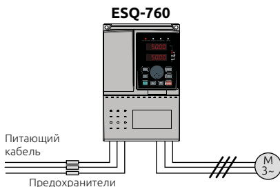
Рисунок 3-23. Схема установки предохранителей.
