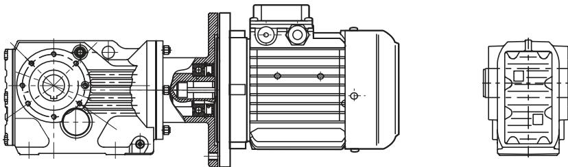
а) Редуктор **КА** – полый выходной вал, резьбовые отверстия на корпусе. Имеет возможность установки реактивной штанги, возможность установки цельного выходного вала и выходного фланца.
