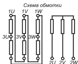
Схема соединений на панели
