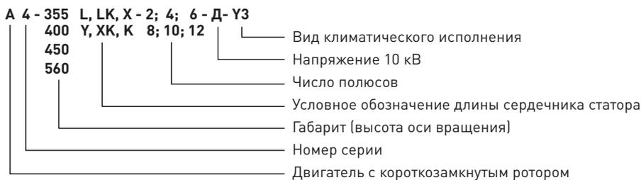
Стандартное исполнение электродвигателей серии А4 обеспечивает следующие параметры:
