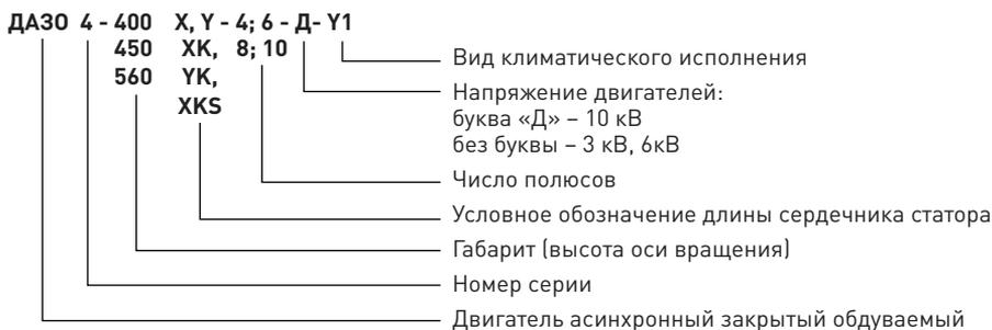
Стандартное исполнение электродвигателей серии ДАЗО4 обеспечивает следующие параметры:
