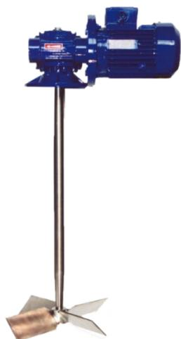
4-х лопастные низкооборотные мешалки предназначены для перемешивания жидкостей (флокулянтов, коагулянтов, растворов полиэлектролитов и т.п.), в объеме не более 5 м3. Стандартное исполнение электродвигателя: 230/400V-50Hz - 3 фазы, 1400 об/мин. Редуктор: 70 – 90– 140 об/мин. Стандартное исполнение: вал с 4-мя рабочими лопастями выполнен из н/ст AISI 304 под углом 45 градусов.
