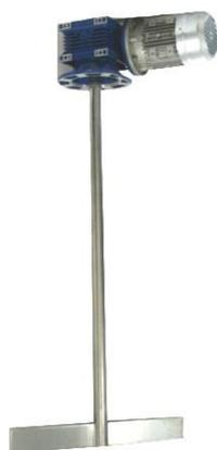
2-х лопастные низкооборотные мешалки предназначены для перемешивания жидкостей (флокулянтов, коагулянтов, растворов полиэлектролитов и т.п.). Стандартное исполнение электродвигателя 230/400V-50Hz - 3 фазы, 1400 об/мин. Редуктор: 70 – 140– 186,7 об/мин. Стандартное исполнение: вал с 2-мя рабочими лопастями выполнен из н/ст AISI 304 под углом 90 градусов.
