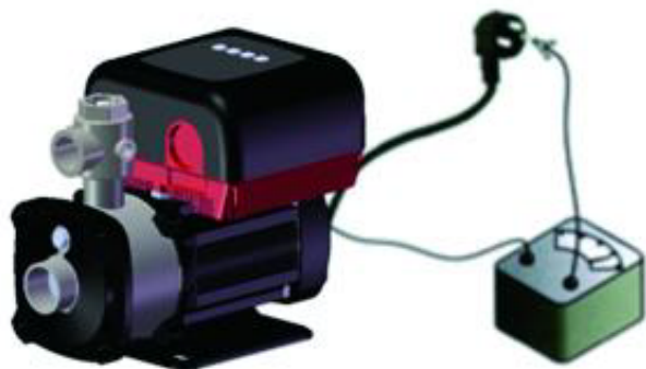
Рис.1 – Проверка сопротивления изоляции кабеля
