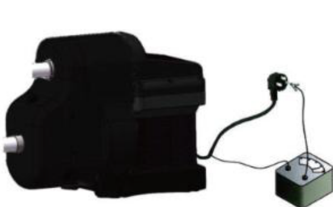
Рис.1 – Проверка сопротивления изоляции кабеля
