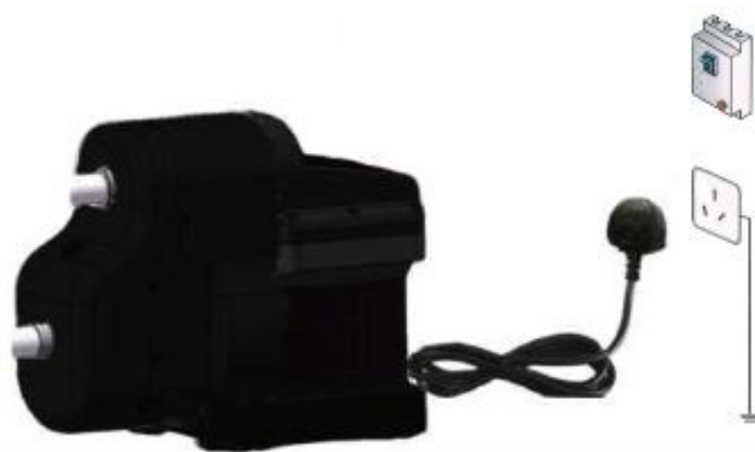
Рис.2 – Заземление розетки питания
