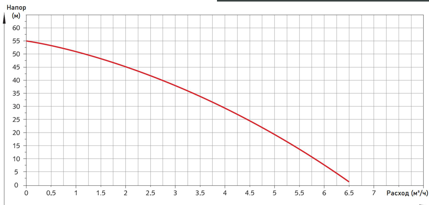
Рис.7 – График напорно-расходной характеристики PL1100
