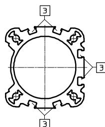
В этом исполнении датчики положения поршня могут устанавливаться с 3-х сторон пневмоцилиндра
