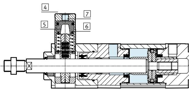
С фиксатором поршня в конечных положениях
