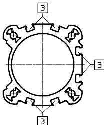
При выборе в модульной системе заказа опции D3 пневмоцилиндр будет иметь пазы с 3-х сторон для установки датчиков положения поршня.
