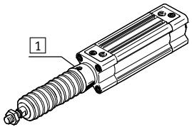
Заданные гофры являются полностью герметичными. Для предотвращения попадания пыли и химически агрессивных сред внутрь соединение их внутренней полости с окружающей средой должно осуществляться через
