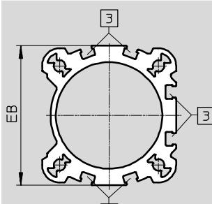
█ Монтажный паз для датчиков положения
