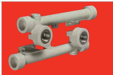
У вас была когда-нибудь проблема с установкой смесителя? При прокладке труб под штукатуркой удобно использовать специальный настенный комплект, шаг перестановки которого такой же, как стандартное расстояние между точками подключения смесителя – 100, 113, 137 или 150 мм. С помощью данной перестановки можно исключить неправильную прокладку труб к смесителю.
