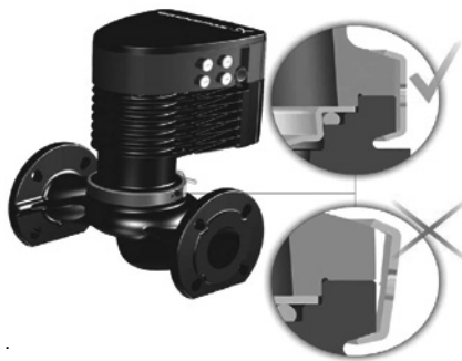
Рис. 16 Закрепление головной части насоса на корпусе насоса
