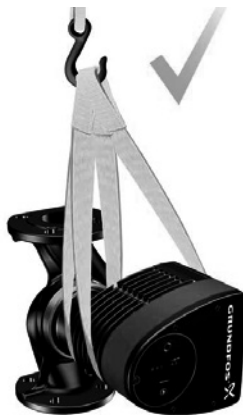
Рис. 7 Правильный способ строповки насоса
