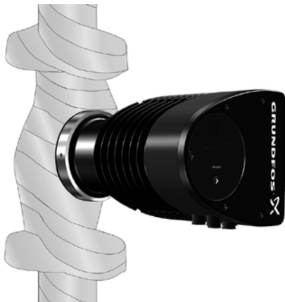
19-сур. Сорғы корпусын және құбыр желісін оқшаулау
