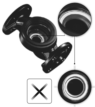
Рис. 17 Неправильно выровненная система уплотнений
