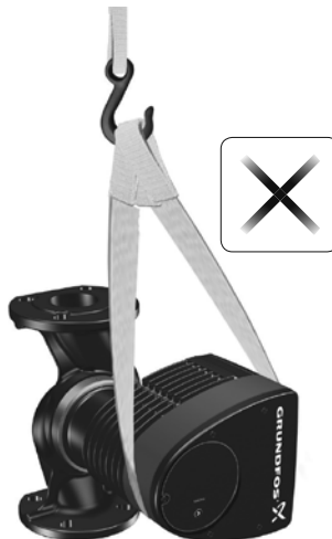
Рис. 10 Неправильный способ строповки насоса
