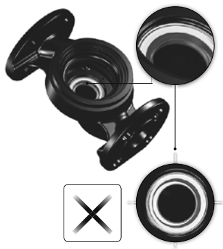
17-сүр. Туура эмес тегизделген тыгыздоо тутуму
