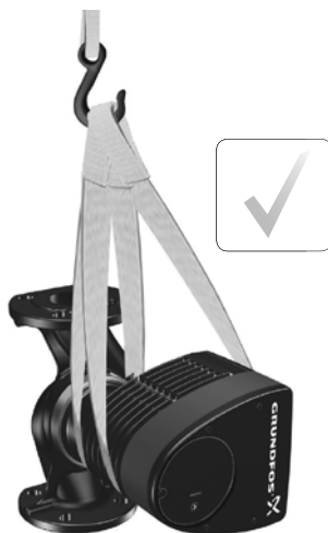
Рис. 9 Правильный способ строповки насоса
