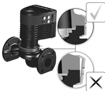
18-сүр. Соркысманын корпусуна соркысманын баш бөлүгүн бекитүү
