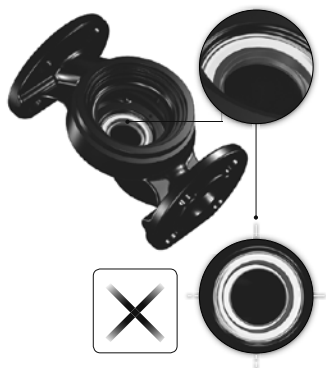
Նկար 17 Խցվածքների սխալ հավասարեցրած համակարգ
