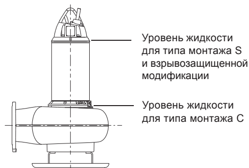
Рис. 8 Временная погружная установка насоса
