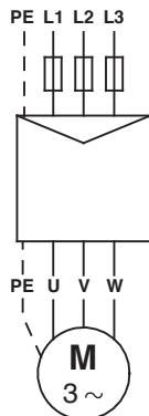
Рис. 23 Электродвигатели Grundfos - прямой пуск
