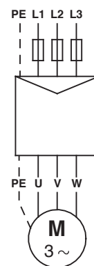
23-сур. Grundfos электрлі қозғалтқыштары - тікелей қосу
