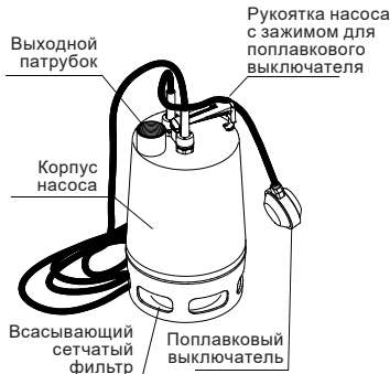
Рис. 1 Конструкция насосов Unilift AP
