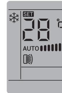
Внешний вид дисплея при выключенном кондиционере
