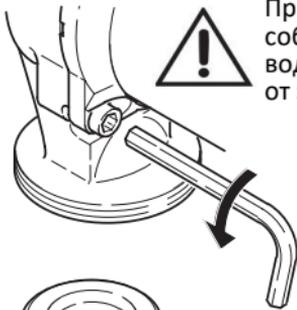
При проведении любых работ с насосом, необходимо соблюдать меры предосторожности от ожогов горячей водой. Перед началом работ насос должен быть отключен от электросети.
