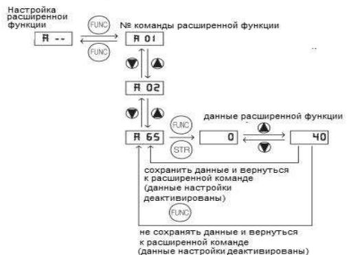
③ Пример того, как частота задается потенциометром стандартного устройства управления, и оборудование начинает работать.
