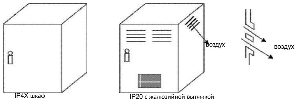
Рис 1. Шкаф инвертора
