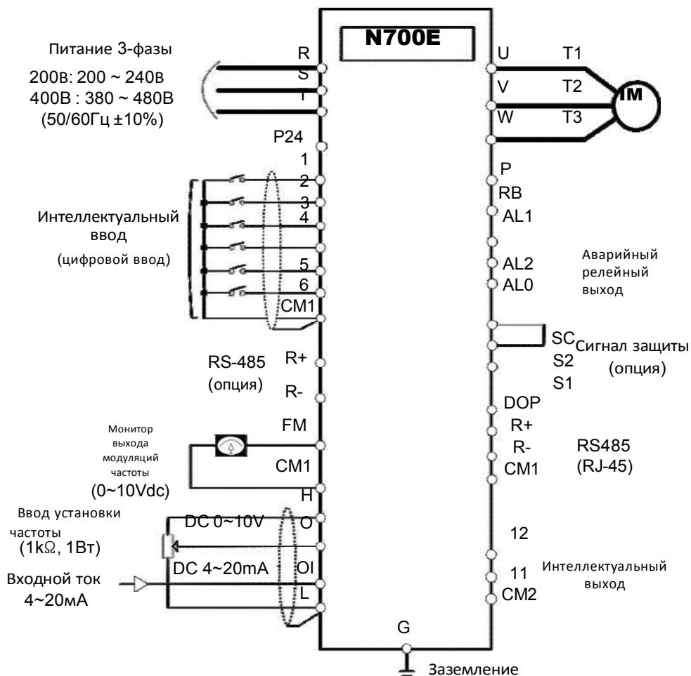
Рис. 3-1 Схема настройки при помощи управления клеммами.
