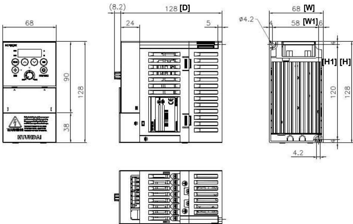
(2) Габаритные размеры модели N700E-015SF/004HF/007HF/015HF/022SF/022LF/022HF.(мм.)
