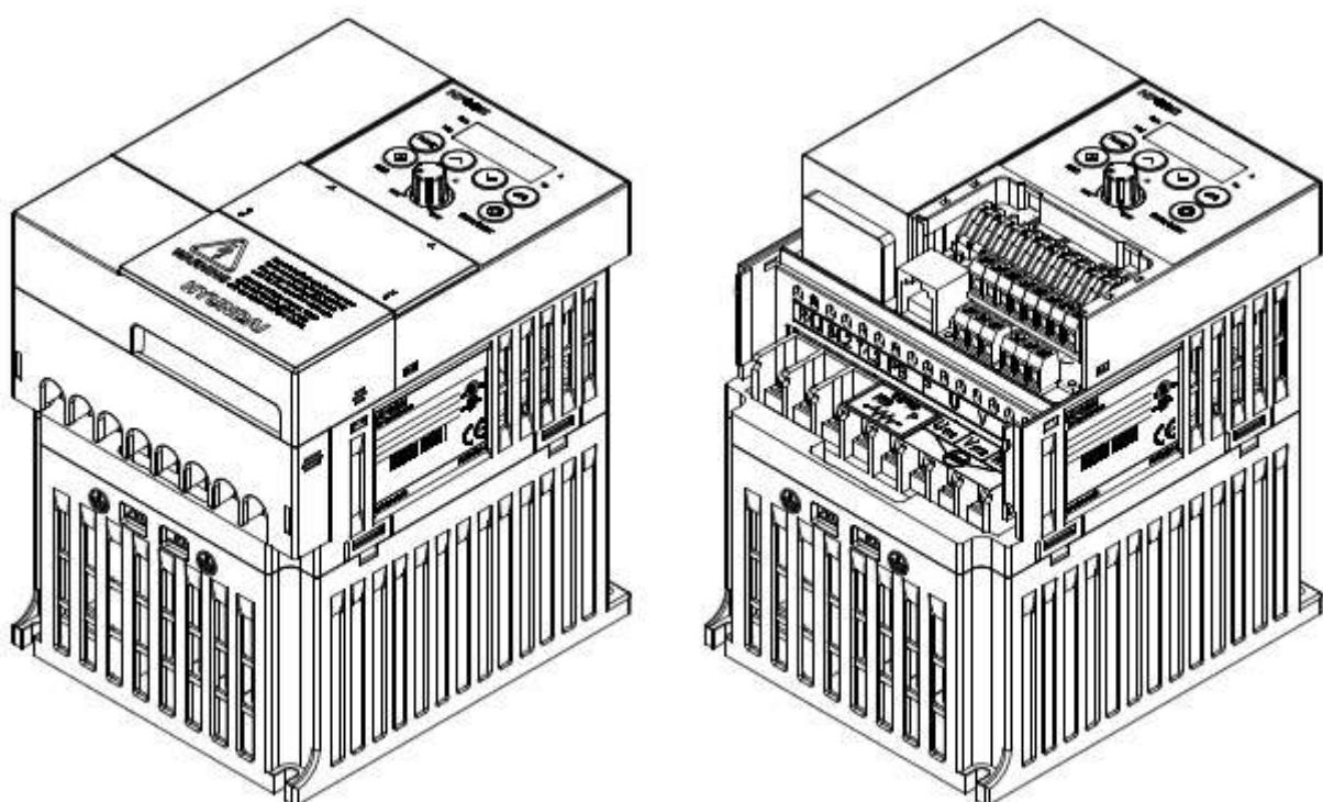
Рис. 1-4 Внешний вид инвертора N700E (2 конструкция)
