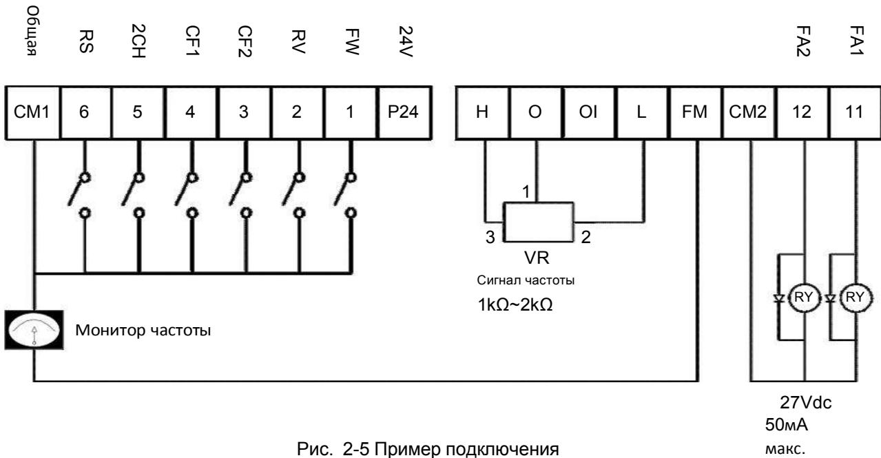
Рис. 2-5 Пример подключения основной PCB
