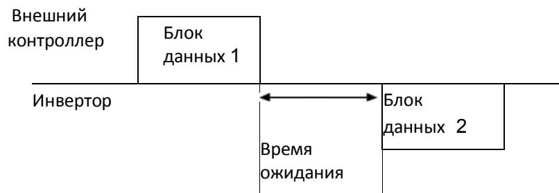
**Начало блока данных:** Начало блока данных распознается переданными линейными данными сигнала.
