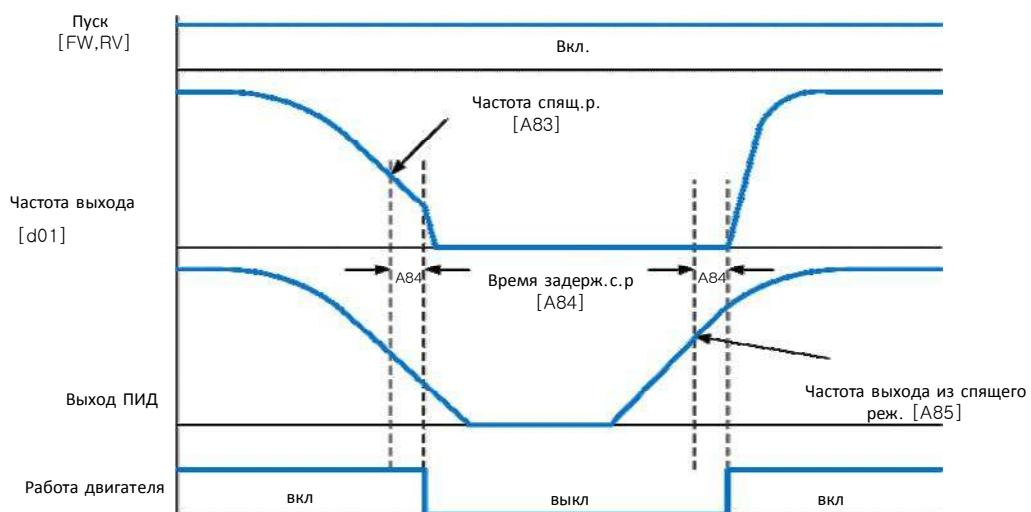
Рис. 4-3 Спящий режим/выход из спящего режима
