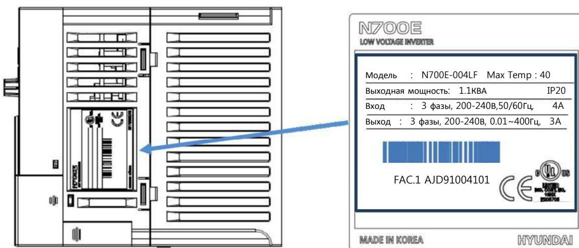
Рис. 1-2 Содержание бирки с техническими характеристиками
