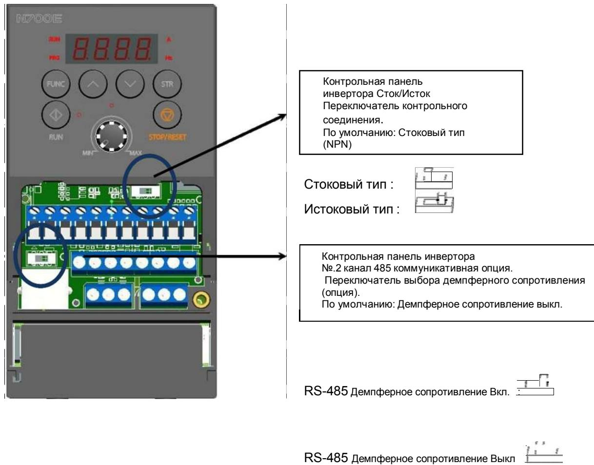
Рис. 2-6 Переключатель выбора контрольной панели и методы установки.
