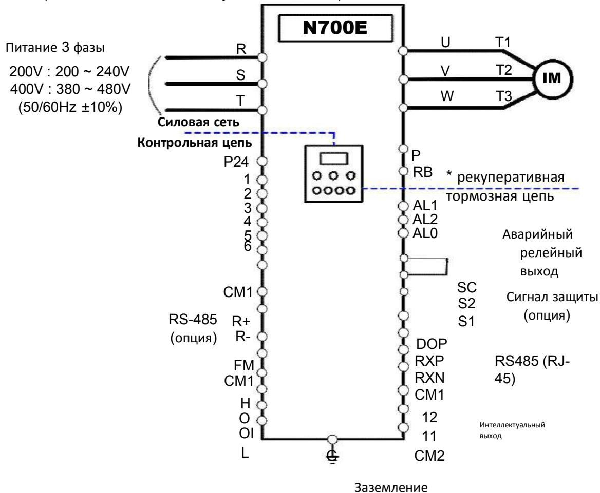
Рис. 3-2 Схема настройки с панели устройства управления
