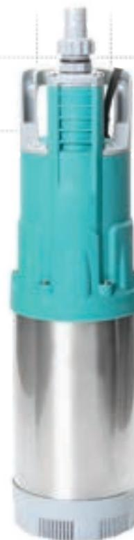
Серия насосов оснащена теми же гидравлическими элементами, что и в случае насосов Multi IP 800 INOX, но вместо поплавкового выключателя в них встроены автомат управления насосом. Когда выпускной клапан закрыт, насос выключается и переходит в режим ожидания, поддерживая постоянное давление в системе. Насос автоматически включается при открытии выпускного клапана.
