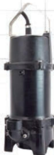
Насос UP60/80 оснащен двухступенчатой гидравликой, увеличивающей максимальное давление. Важной особенностью модели UP является многоканальный дисковый измельчитель, в котором риск блокировки сведен к минимуму. Кроме того, соединитель снабжен резьбовым патрубком, предназначенным для соединения трубопровода или быстроразъемного соединения. Насос имеет тепловую защиту, установленную в обмотке двигателя.
