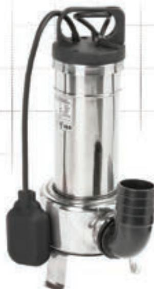
Погружные насосы из нержавеющей стали с системами измельчения. Предназначен для перекачки грязной воды и бытовых сточных вод. Использование открытого измельчителя снижает риск засорения до минимума. Благодаря высочайшему качеству нержавеющей стали, насосы обеспечивают длительную бесперебойную работу. Двигатель оснащен тепловой защитой, установленной в обмотке. Кроме того, насосы имеют поплавковый выключатель, который автоматически контролирует работу насоса.
