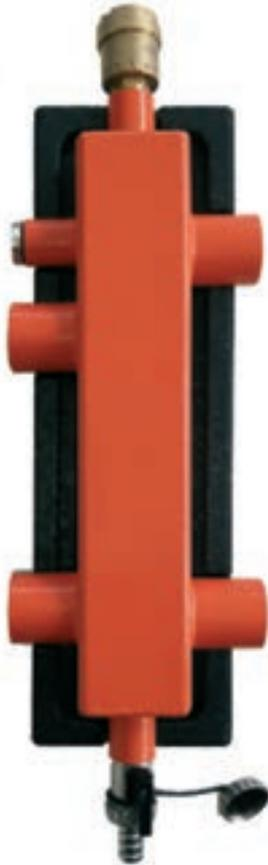
Задача гидравлического Сцепления - отделить контур котла от контура отопления, уравновесить потоки и обеспечить бесперебойную работу насосов. Дополнительная функция сцепления - защита котла от слишком низкой температуры обратной магистрали.
