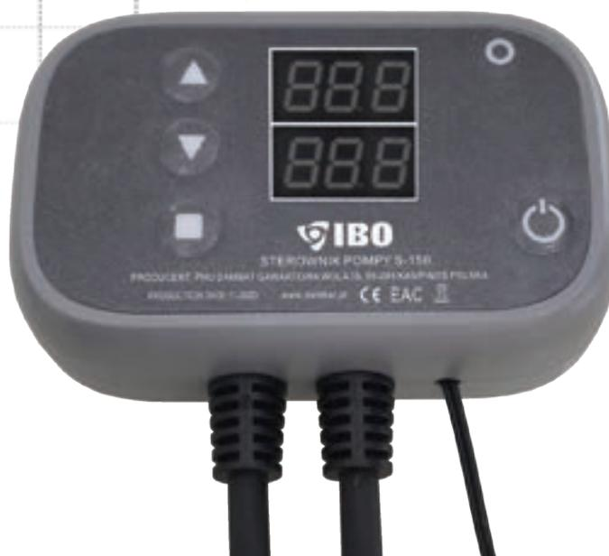
Контроллер оснащен 2-мя светодиодными дисплеями. Текущая температура, измеренная датчиком, стандартно отображается на верхнем, а на нижнем - температуре выключения. Кнопка MENU переключает контроллер в режим предварительного просмотра и настройки температуры для выключения, включения и настройки функции антистоп.
