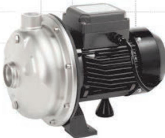
Одноступенчатые центробежные насосы, нормально всасывающие, для перекачки неагрессивных жидкостей, с содержанием неабразивные и неабсорбирующие твердых нечистот а в количестве 0,27 кг/м<sup>3</sup>. Максимальная температура перекачиваемой жидкости до 60°C. Двигатель насоса оснащен тепловой защитой, встроенной в обмотку. Гидравлические компоненты, которые вступают в контакт с водой, полностью изготовлены из нержавеющей стали.
