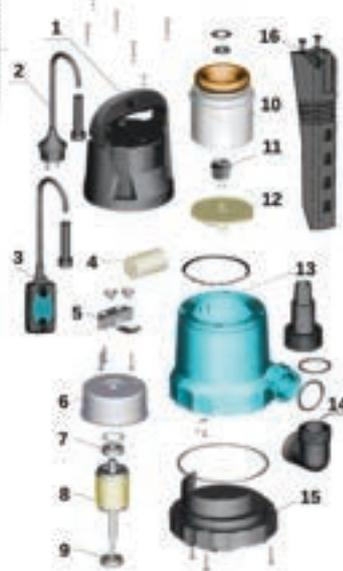
IPE 400 – Погружной пластиковый насос для чистой и слегка загрязненной воды. В насосах используется нагнетательный патрубок, для которого могут быть подобраны различные диаметры нагнетательного шланга. IPE400 оснащен электронным поплавком / зондом, поэтому его можно использовать в узких скважинах. Малые размеры и вес делают насосы чрезвычайно простыми в использовании и обслуживании. Все насосы имеют встроенную тепловую защиту.
