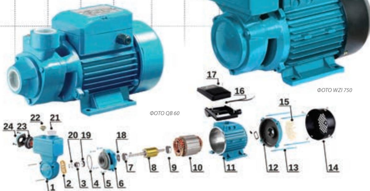
Одноступенчатые самовсасывающие поверхностные периферийные насосы, предназначенные для перекачивания чистой, холодной воды из собственных водозаборов и для повышения давления. Лопастные колеса насосов выполнены из латуни. В корпус насоса, выполненный из твердого чугуна, заводским способом встроены обратный клапан. Двигатель насоса оснащен тепловой защитой. Насосы имеют шнур питания с вилкой.
