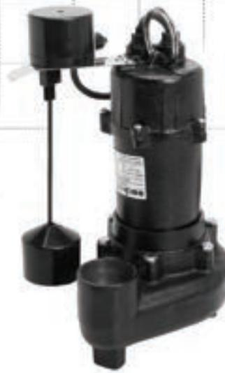
Серия погружных насосов для перекачки сточных вод, грязной воды и воды из затопленных помещений. Насос SN-450 изготовлен из чугуна с лопастным колесом типа VORTEX. Может перекачивать воду, содержащую механические примеси диаметром до 20 мм. Насос оснащен поплавковым выключателем, который обеспечивает бесперебойную автоматическую работу устройства в скважинах диаметром от 25 см. Насос SN-450 оснащен тепловой защитой, установленной в обмотке двигателя.
