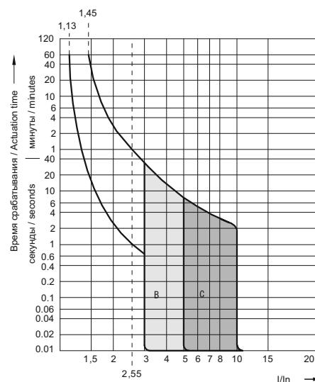
Максимальные значения времени отключения при дифференциальных токах полупериода (действующие значения) для АВДТ типа А / Maximum values of breaking time at the half-wave impulse residual current (root mean square) for RCBO of A type
