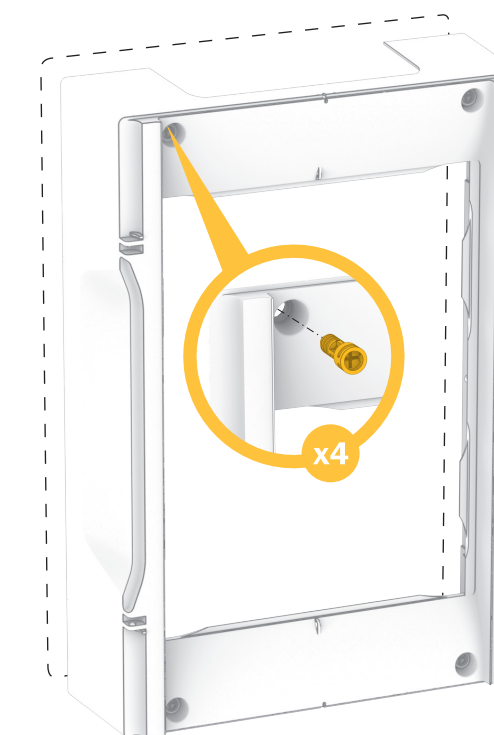
1.7 Крепление крышки к основанию Mount of the cover to the base
