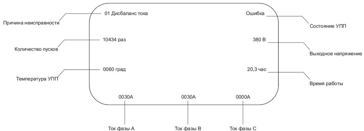
Рисунок 3.13 – Запись о неисправности
