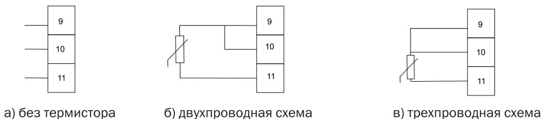
Рисунок 3.5 – Схемы подключения термистора
