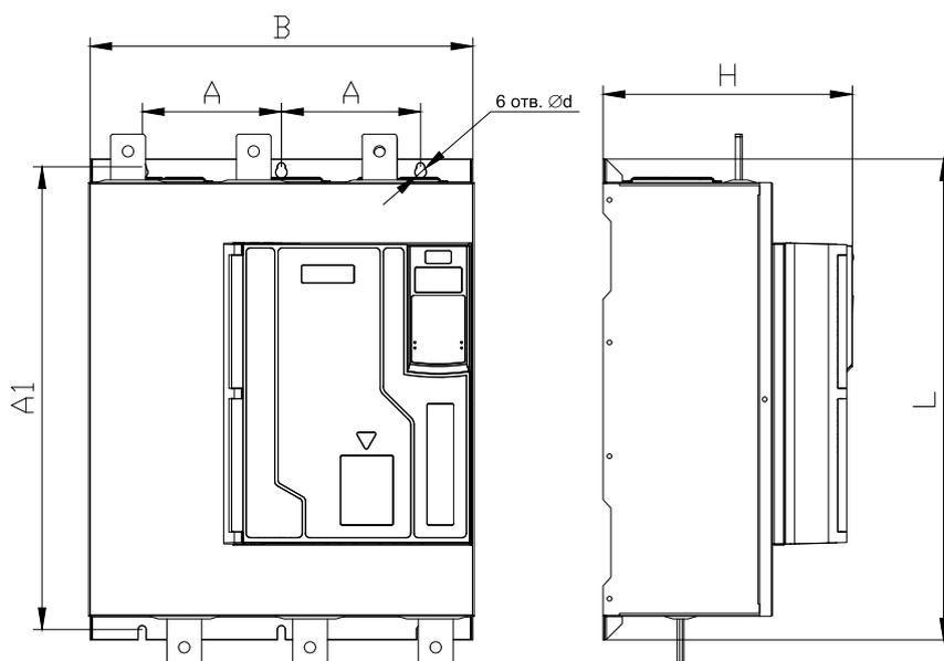
Рисунок 2.4 – Габаритные и установочные размеры УПП, габарит 3
