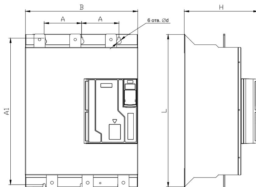
Рисунок 2.5 – Габаритные и установочные размеры УПП, габарит 4
