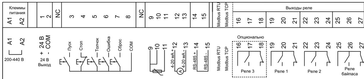
Рисунок 3.3 – Клеммы управления
