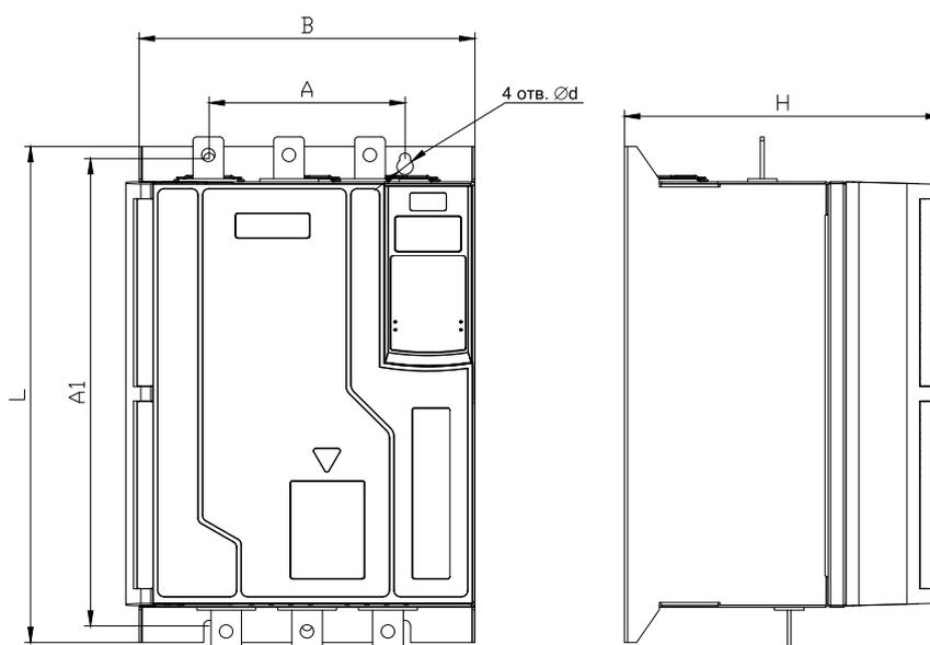
Рисунок 2.3 – Габаритные и установочные размеры УПП, габарит 2
