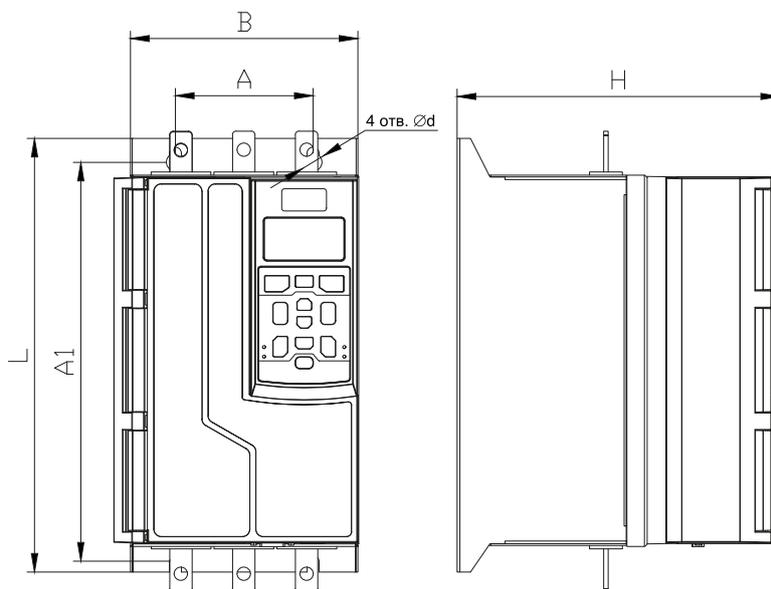
Рисунок 2.2 – Габаритные и установочные размеры УПП, габарит 1
