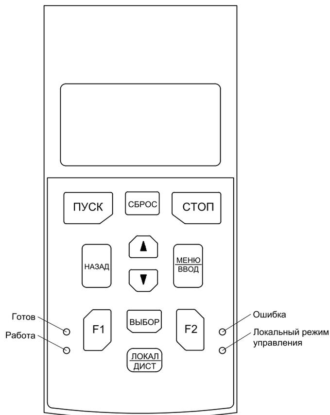
Рисунок 3.9 – Кнопочная панель управления
