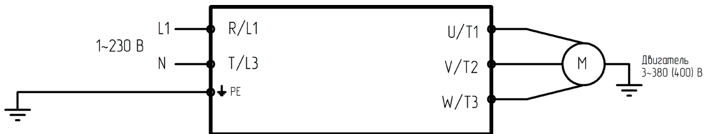
Рисунок 5. Подключение силовых клемм
