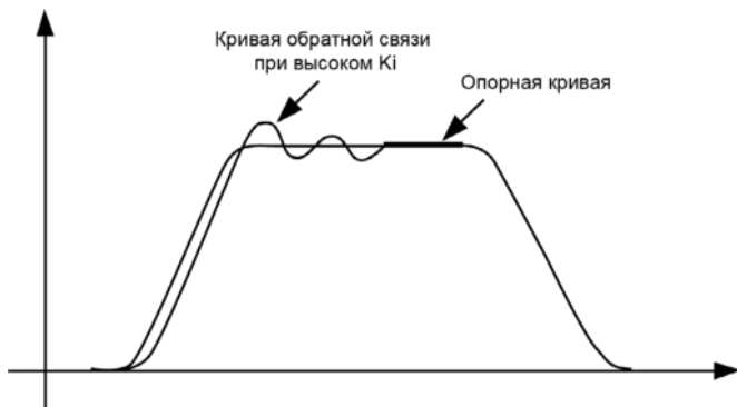
Рис. 6.31 - Влияние K_i на кривую обратной связи
