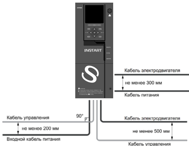
Рис. 3.6 - Графическое представление расстояний между кабелями
