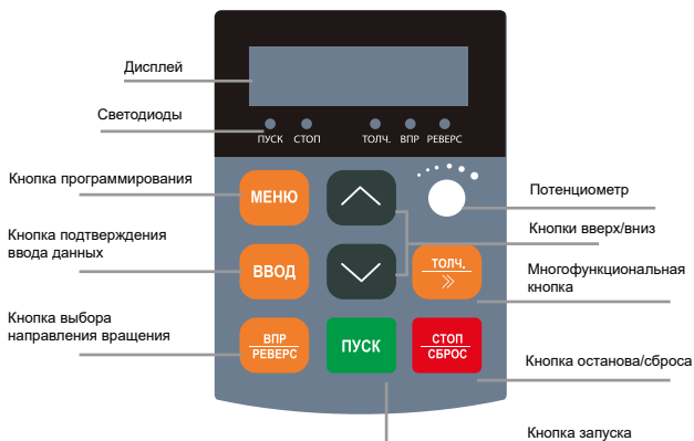
Рис. 5.2 Функции кнопок и светодиодов панели управления LCI(S)
