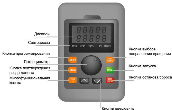
Рис. 5.1 Функции кнопок и светодиодов панели управления LCI
