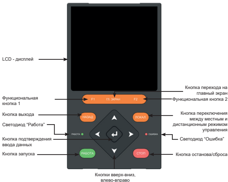
Рис. 5.1 Функции кнопок и светодиодов панели управления INPRIME
