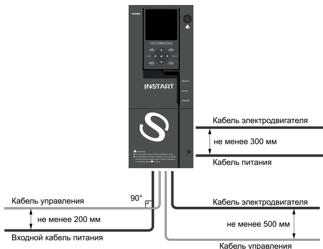
Рис. 3.6 Графическое представление расстояний между кабелями
