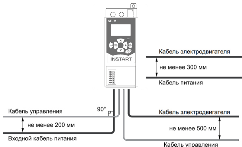
Рис. 7. Графическое представление расстояний между кабелями
