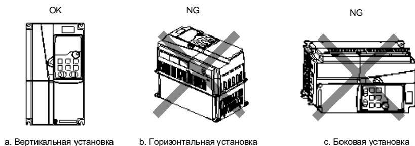
Рисунок 4-1 Направление монтажа частотно-регулируемого привода (ЧРП)
