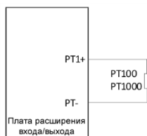
Рисунок 5-25 PT100/PT1000, измеряющий температуру через плату расширения
