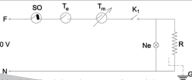
Schéma elektrického obvodu konvektora s manuálnym ovládaním
