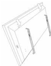
Figura 10. L'inserimento del gancio superiore, veduta da dietro
