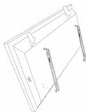
Fig. 10 Vedere spate dispozitiv fixare
