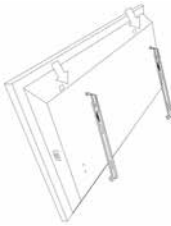
Şekil 10. Üst kancanın takılması arkadan görünüş
