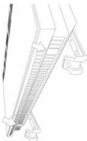
Slika 8: Postavljanje konvektora na doljni dio zidnog nosača
