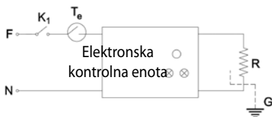
Slika 3. Električna shema digitalnega panelnega grelnika
