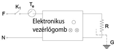
4. ábra Panel konvektor (digitális) elektromos áramkör
