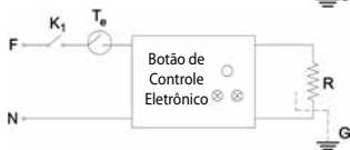
Figura 4. Diagrama do Circuito Elétrico do Convector de Painei com Unidade de Controle Digital
