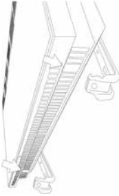
Şekil 8. Alt kancaya konvektörün oturtulması
