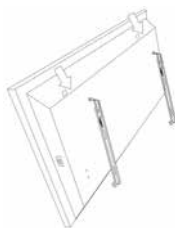
Bild 10. Befestigung des oberen Hakens, Hinteransicht
