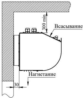
ГОРИЗОНТАЛЬНАЯ УСТАНОВКА к стене с помощью кронштейнов
