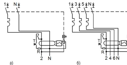
Рисунок Г.1 - Принципиальные электрические схемы АДВТ
