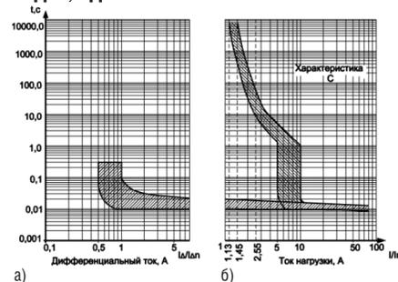
Рисунок Б.1 - Время-токовые характеристики отключения АДВТ
