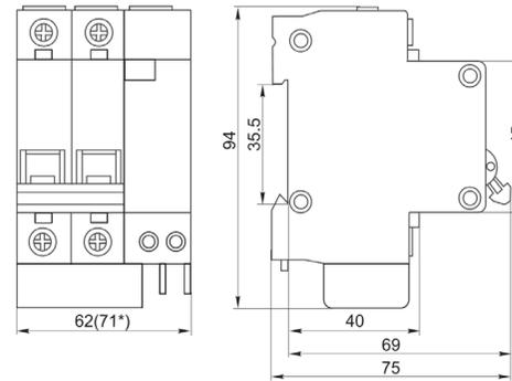
Рисунок В.1 Габаритные, установочные и присоединительные размеры двухполюсного АДВТ типа АД12
