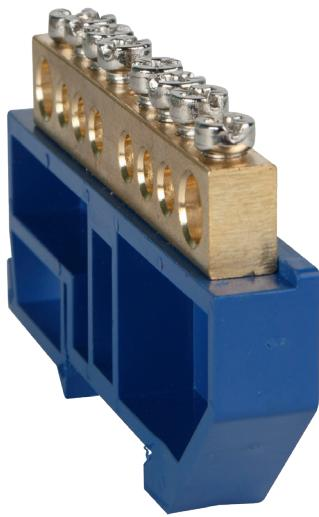
Шины предназначены для электрического и механического соединения нулевых рабочих, нулевых защитных и фазных проводников в электрощитовом оборудовании и электроустановках с напряжением до 400 В переменного и постоянного тока. Основными функциями изделия являются:
