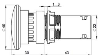
Рисунок А.3 – Выключатель OptiSignal Compact D22 C7-P30
