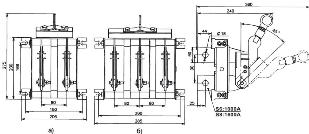
**Рисунок Б.32** — Разъединитель РЕ19 с центральной рукояткой, заднего присоединения шин
