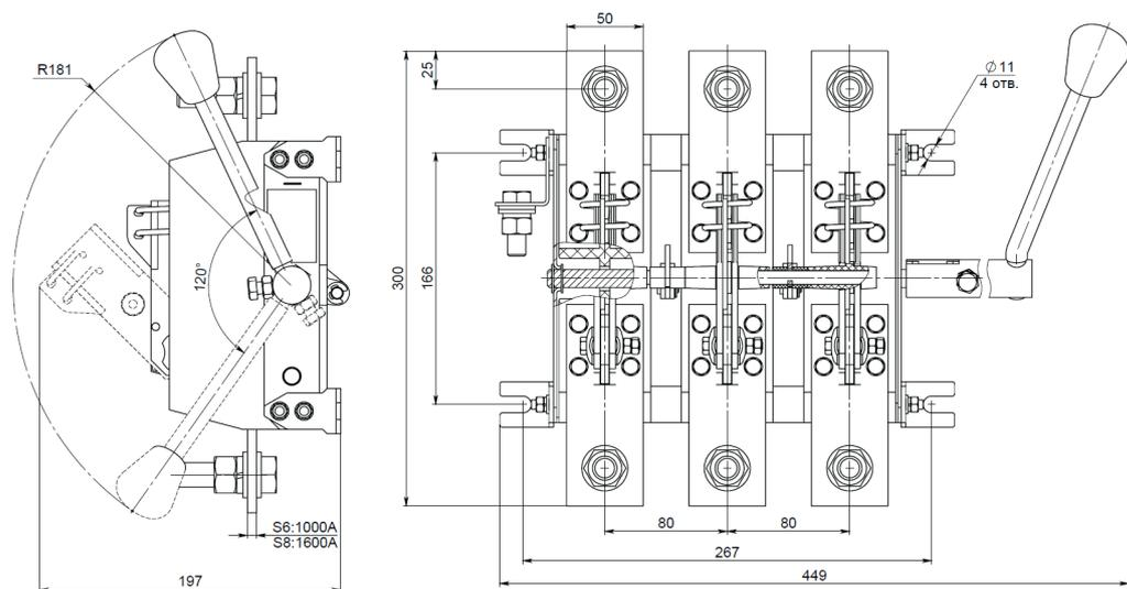
**Рисунок Б.18** — Разъединитель PE19-41(43)-32250-00 УХЛЗ с боковой смещенной рукояткой, заднего присоединения шин
