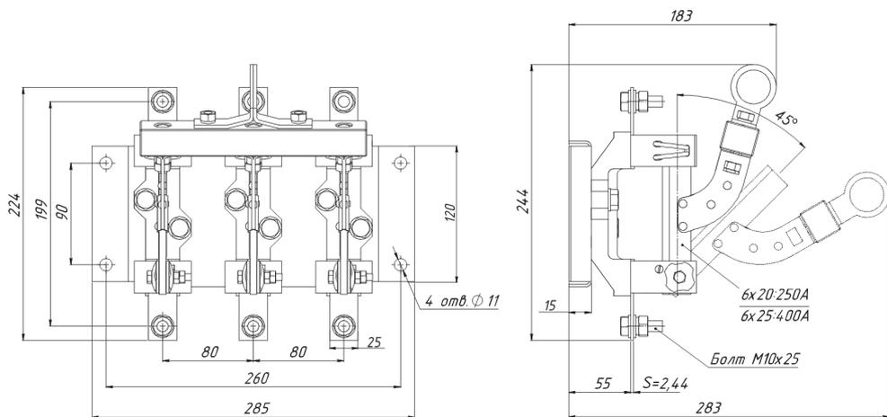
**Рисунок Б.4** — Разъединитель РЕ19-35(37)-31170-00 УХЛ3 с рукояткой для полюсного оперирования
