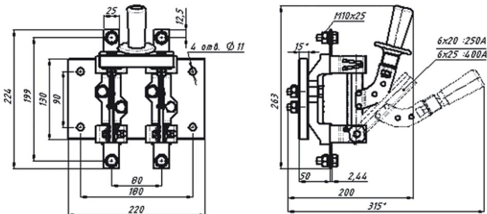
Рисунок Б.2 — Разъединитель PE19-35(37)-31110-00 УХЛЗ трехполюсный с центральной рукояткой
