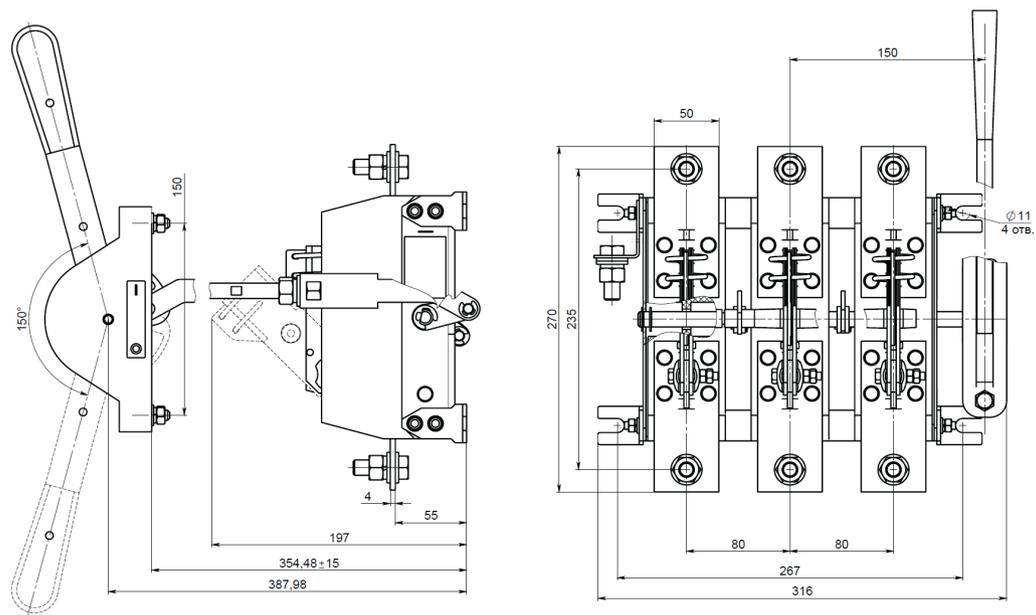
Рисунок Б.11 — Разъединитель PE19-39-21170-00 УХЛЗ с рукояткой для полюсного оперирования
