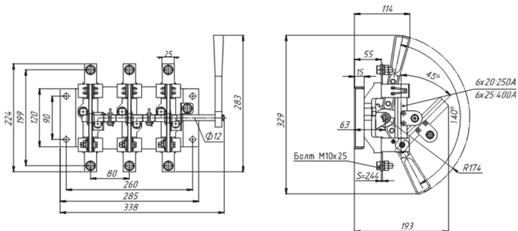
**Рисунок Б.7** — Разъединитель PE19-35(37)-31140-00 УХЛЗ с передней смещенной рукояткой
