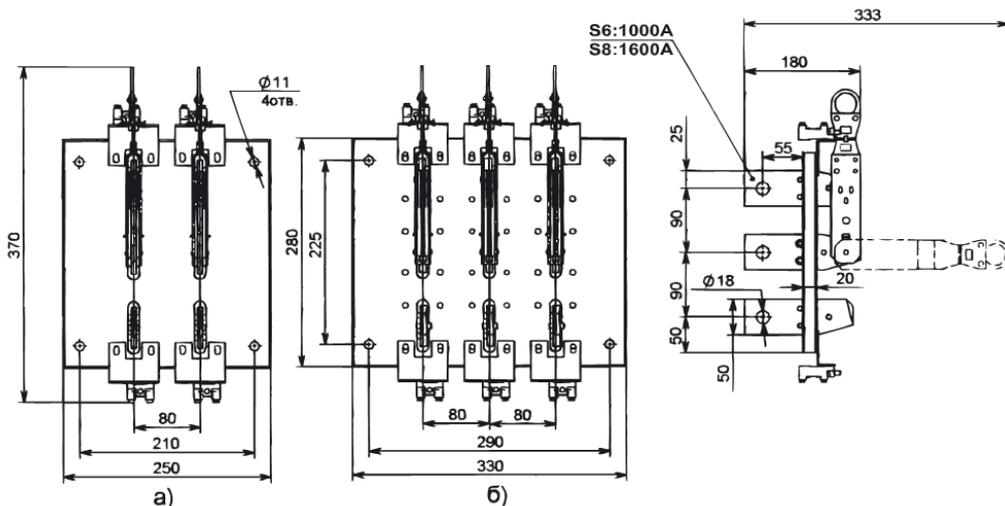
Таблица Б.16 — Разъединитель РЕ19 на два направления с рычагом для полюсного оперирования штангой
