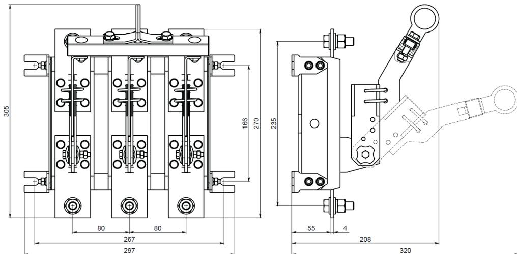
Рисунок Б.9 — Разъединитель РЕ19-39-31120-00 УХЛЗ с боковой рукояткой
