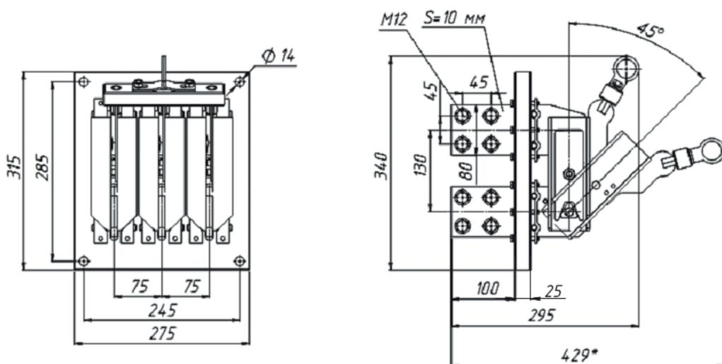
**Рисунок Б.55** — Разъединитель РЕ19 с рычагом для полюсного оперирования штангой
