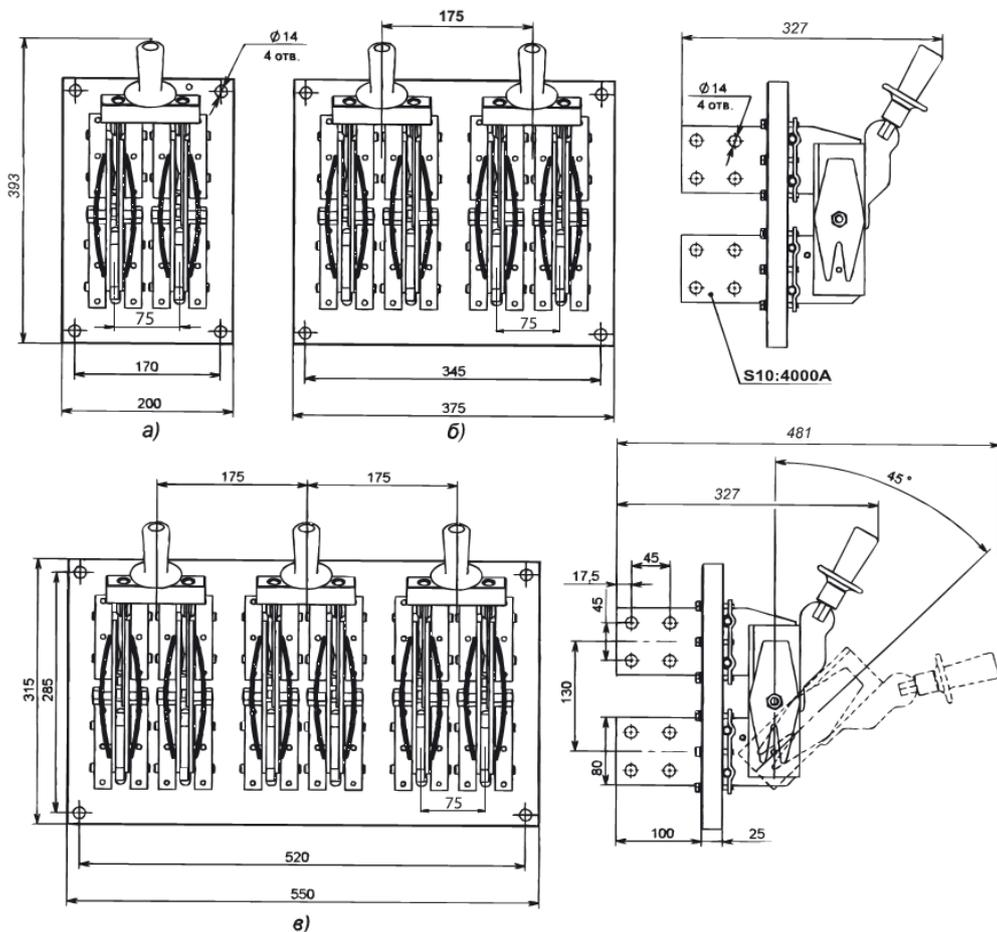
**Таблица Б.22** — Разъединитель РЕ19 с рукояткой для пополюсного оперирования
