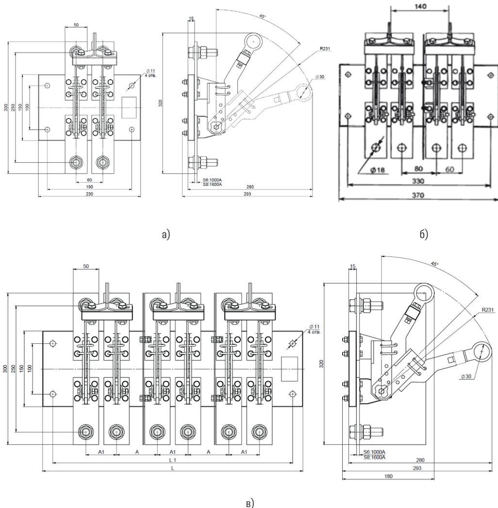
**Таблица Б.17** — Разъединитель РЕ19 с рычагом для пополюсного оперирования штангой, на изоляционной плите
