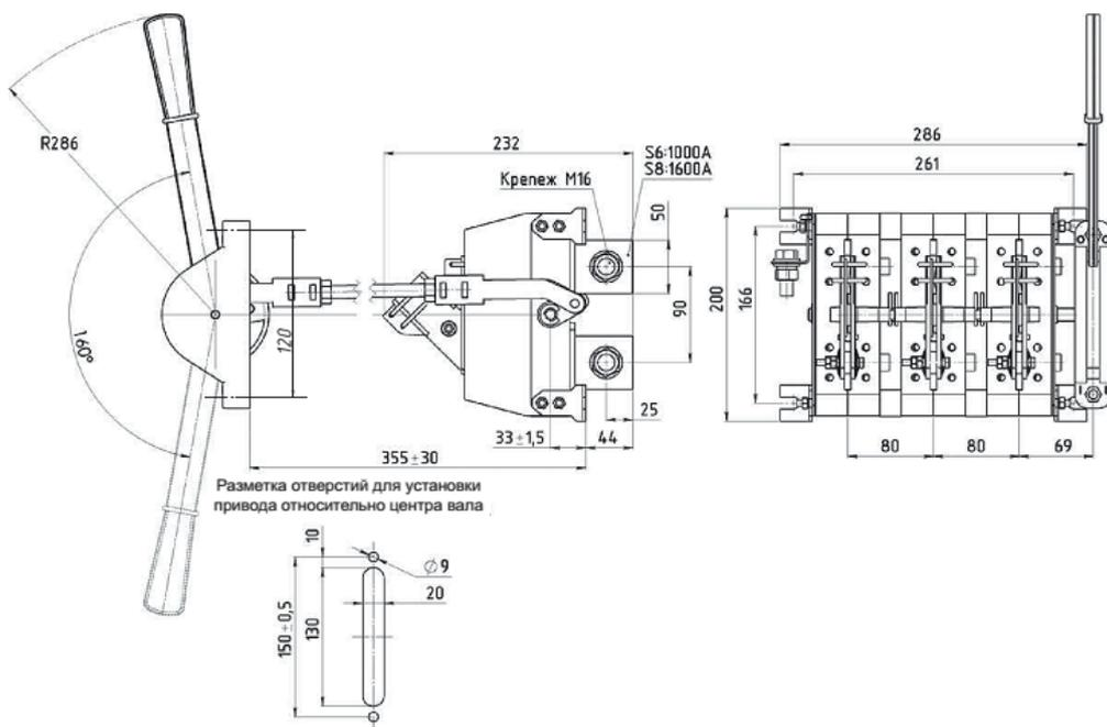
**Рисунок Б.17** — Разъединитель PE19-41(43)-31150-00 УХЛЗ с боковой смещенной рукояткой
