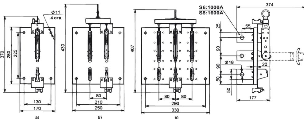
Таблица Б.14 — Разъединитель РЕ19 на два направления с центральным рычагом для управления штангой
