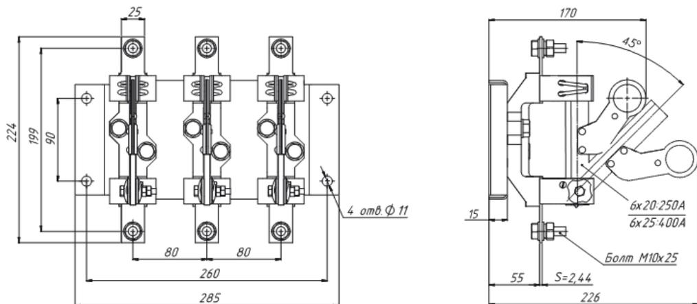
Рисунок Б.6 — Разъединитель PE19-35(37)-31120-00 УХЛ3 с боковой рукояткой
