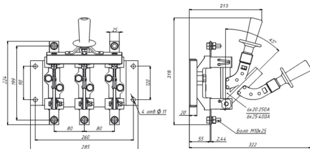
**Рисунок Б.3** — Разъединитель РЕ19-35(37)-31190-00 УХЛ3 с центральным рычагом для управления штангой
