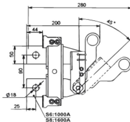
**Рисунок Б.23** — Разъединитель РЕ19 с рычагом для пополюсного оперирования штангой, на изоляционной плите
