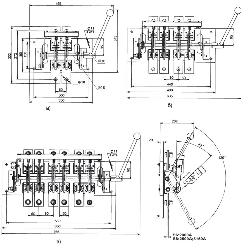
**Рисунок Б.50** — Разъединитель РЕ19 с боковой рукояткой, заднего присоединения шин
