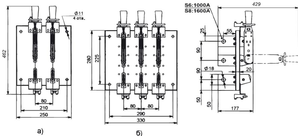
Таблица Б.15 — Разъединитель РЕ19 на два направления с рукояткой для пополюсного оперирования
