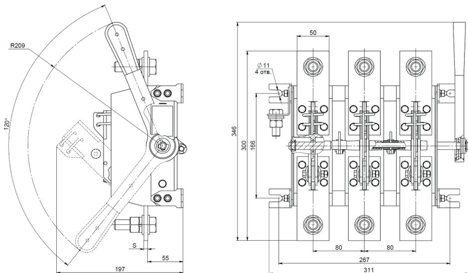
Рисунок Б.14 — Разъединитель РЕ19-41(43)-31140-00 УХЛЗ с передней смещенной рукояткой
