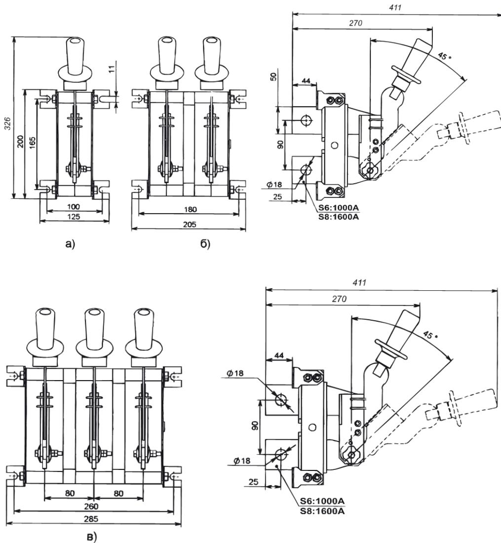
**Рисунок Б.27** — Разъединитель РЕ19 с рукояткой для полюсного оперирования, на изоляционной плите
