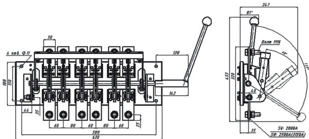
**Рисунок Б.52** — Разъединитель РЕ19 на два направления с рычагом для пополюсного оперирования штангой
