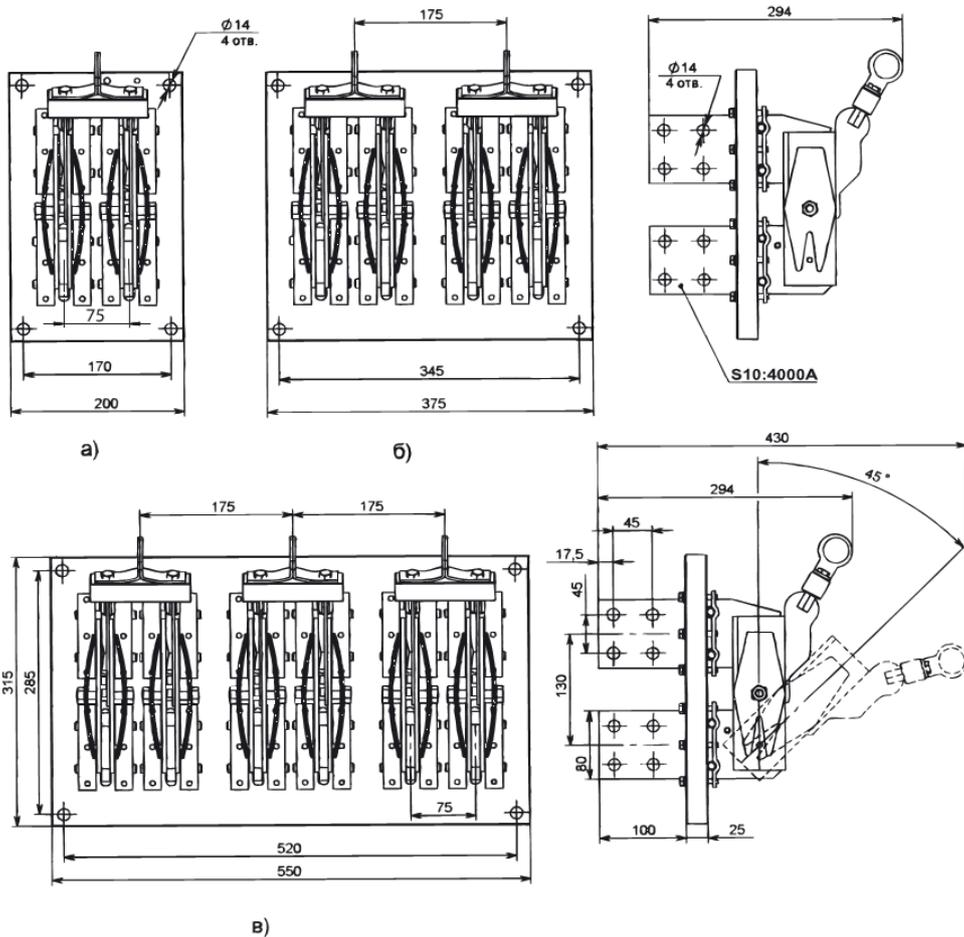
**Таблица Б.21** — Разъединитель РЕ19 с рычагом для полюсного оперирования штангой
