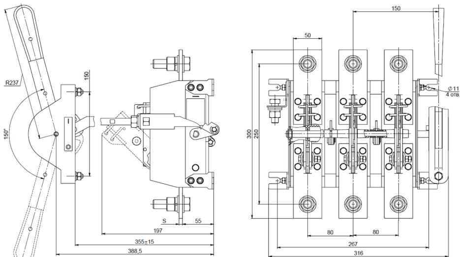
**Рисунок Б.15** — Разъединитель РЕ19–41(43)-32220–00 УХЛЗ с боковой рукояткой, заднего присоединения шин
