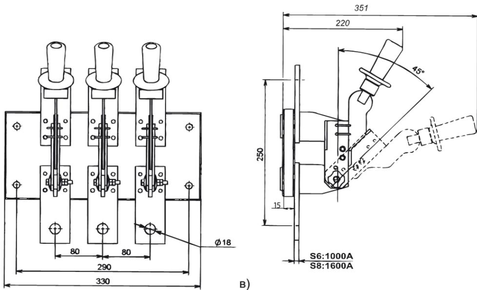
**Рисунок Б.28** — Разъединитель PE19 с рукояткой для пополюсного оперирования, на изоляционной плите заднего присоединения шин
