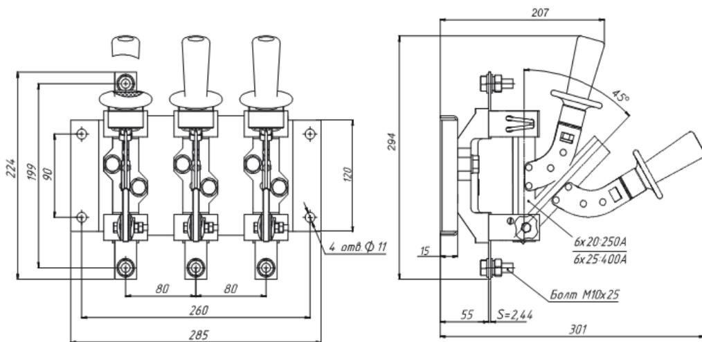
Рисунок Б.5 — Разъединитель PE19-35(37)-31160-00 УХЛ3 с рычагом для полюсного оперирования штангой
