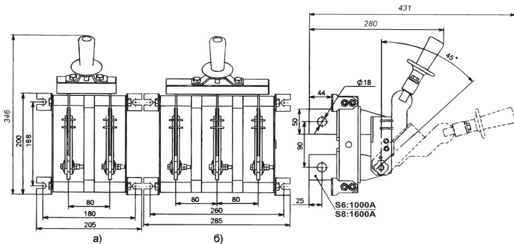
**Рисунок Б.33** — Разъединитель РЕ19 с центральным рычагом для управления штангой, на изоляционной плите (далее — и/п)
