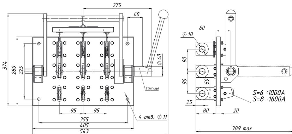
Рисунок Б.42 — Разъединитель РЕ19-41(43)-72250-00 УХЛЗ на два направления с боковой смещенной рукояткой
