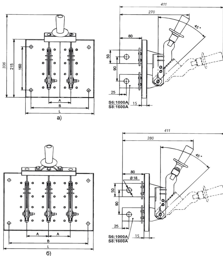
Таблица Б.12 — Разъединитель PE19 с центральной рукояткой, на изоляционной плите заднего присоединения шин
