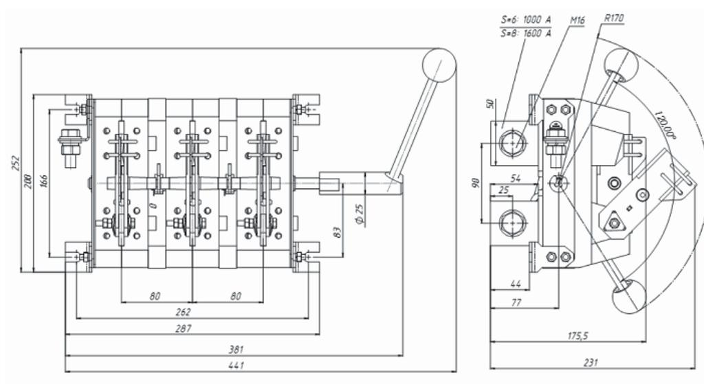
**Рисунок Б.19** — Разъединитель РЕ19–41(43)–31120–00 УХЛЗ с боковой рукояткой на изоляционной плите с межполюсным (далее — м/п) расстоянием 105, 120 и 130 мм
