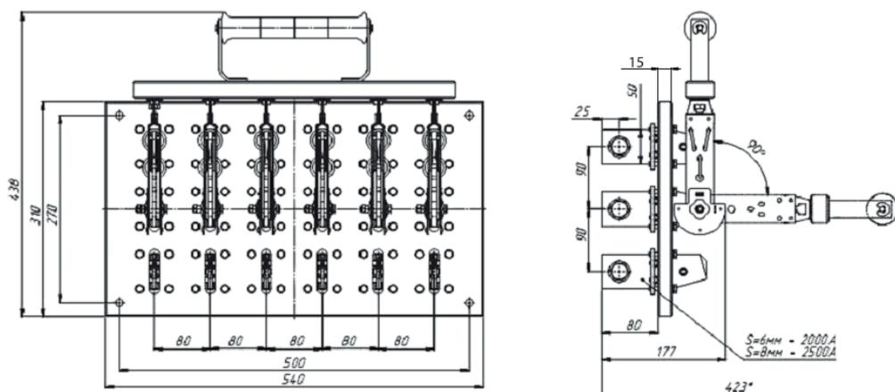
**Рисунок Б.54** — Разъединитель РЕ19 с центральным рычагом для управления штангой
