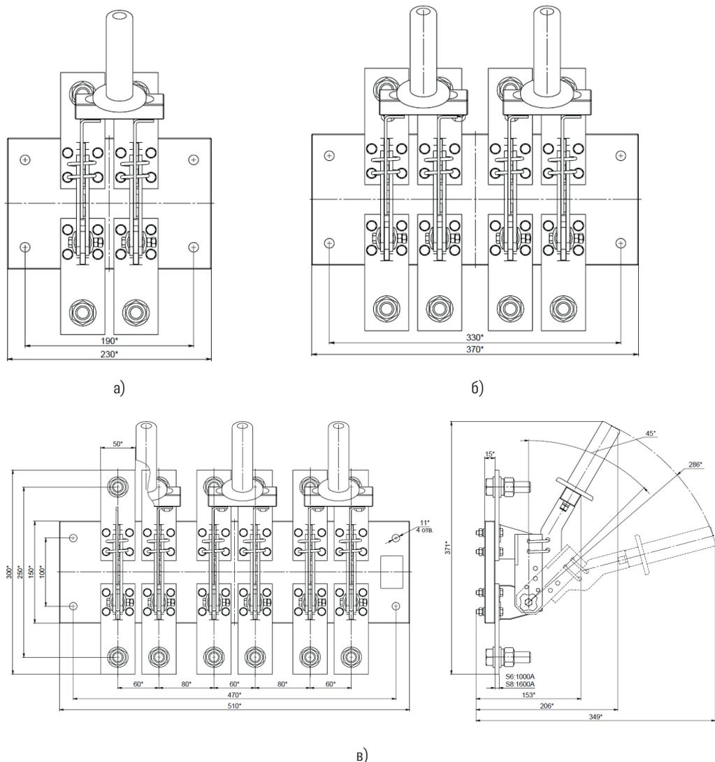
**Таблица Б.19** — Разъединитель РЕ19 с рукояткой для пополюсного оперирования, на изоляционной плите
