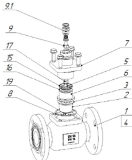
Рисунок 3. Разгруженный по давлению клапан DN 50 – 200. Исполнение Б.
