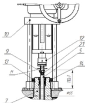
**Демонтаж:** отвести шток 5 в среднее положение. Ослабить стопорную гайку 9, разъединить шток клапана 5 и электропривод 10, распустив стяжную муфту 12 (не допуская при этом поворачивания штока в крышке, удерживая шток за лыски 21). Затем отвернуть стопорные винты 13, снять гайку 14, затем снять электропривод 10 с крышки клапана 7. Снять стопорную гайку 9 со штока 5.
