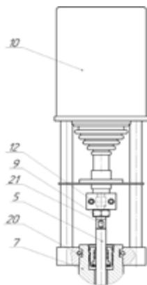
**Демонтаж:** отвести шток 5 в среднее положение. Разъединить шток клапана 5 и электропривод 10, распустив стяжную муфту 12 (не допуская при этом поворачивания штока в крышке, удерживая шток за лыски 21). Затем отвернуть винты 20, затем снять электропривод 10 с крышки клапана 7. Снять стопорную гайку и адаптер штока 9 со штока 5.
