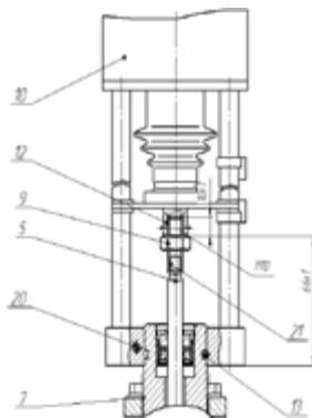
**Демонтаж:** отвести шток 5 в среднее положение. Ослабить стопорную гайку 9, разъединить шток клапана 5 и электропривод 10, распустив стяжную муфту 12 (не допуская при этом поворачивания штока в крышке, удерживая шток за лыски 21). Затем отвернуть стопорный винт 20, отвернуть болт 13, затем снять электропривод 10 с крышки клапана 7. Снять стопорную гайку 9 со штока 5.
