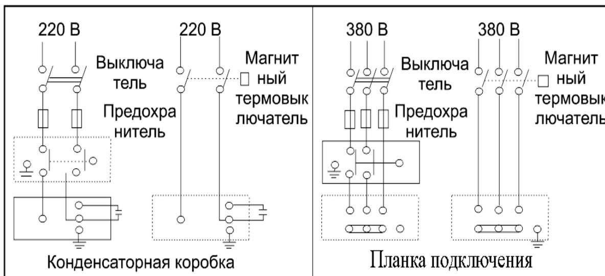
**Внимание!** Указанные в схеме устройства защиты мотора насоса (предохранитель (автомат) и магнитный термовыключатель) не входят в комплект с насосом.
