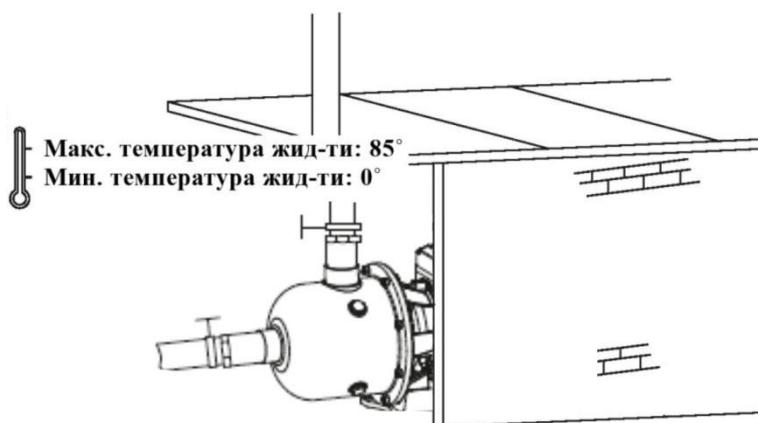
1. Для обеспечения эффективной работы насоса входной трубопровод должен быть, как можно короче, герметичен и надежно зафиксирован. Насос необходимо устанавливать в хорошо проветриваемом и сухом месте, защищенном от прямых солнечных лучей и осадков.
