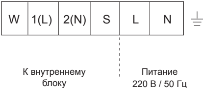
Клеммы для подключения проводов на наружном блоке
