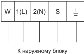
Клеммы для подключения проводов на внутреннем блоке
