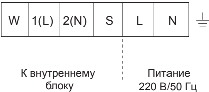
Клеммы для подключения проводов на наружном блоке
