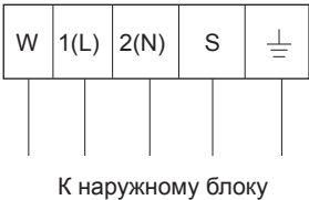
Клеммы для подключения проводов на внутреннем блоке
