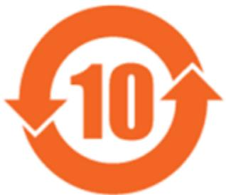
Наблюдение SJT 11364-2014, Маркировка для ограниченного использования опасных веществ в электронных и электрических изделиях.
