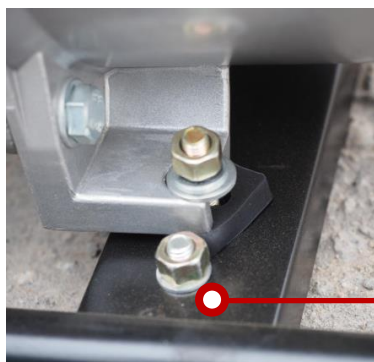
Крепление агрегата к раме через виброкомпенсационные опоры
