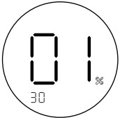
Рис. 14. Настройка времени задержки пуск котла в Эко-режиме.
