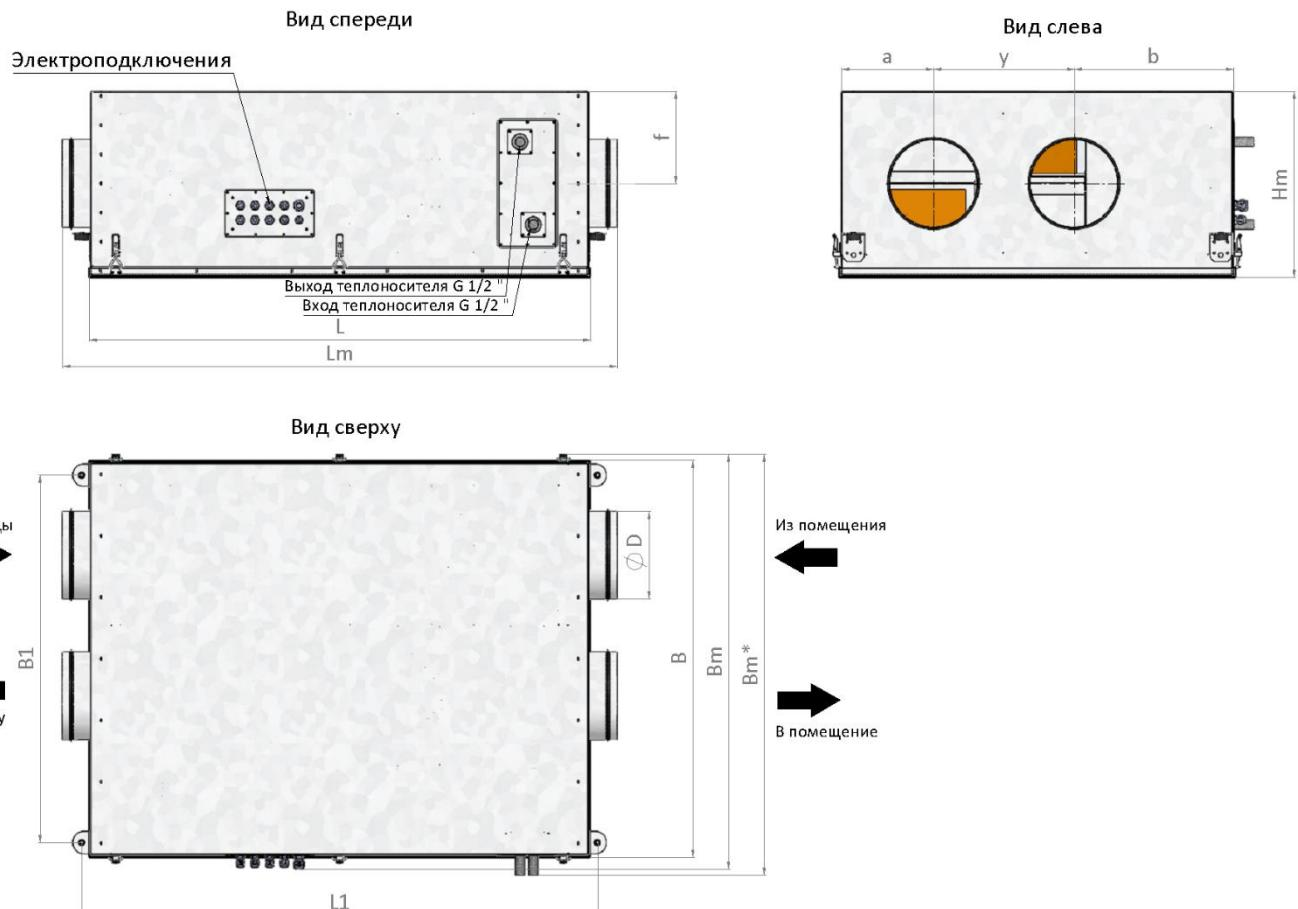
Размер Bm\* соответствует установке с водяным нагревателем.
