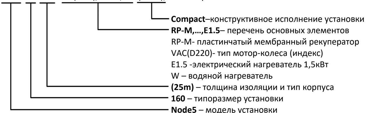
**Конструктивное исполнение:****Compact** – воздуховоды в одной горизонтальной плоскости (подвесное исполнение)**Vertical** – постаментное исполнение – патрубки расположены сверху**Classic** – постаментное (двухэтажное) исполнение – патрубки расположены с торцов, воздуховоды друг над другом.**Условия размещения:**
