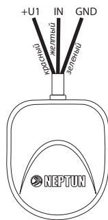
Рис. 7. Маркировка проводов.
