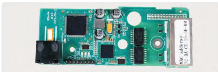
Рисунок 2-1 Внешний вид коммуникационной карты ProFinet
