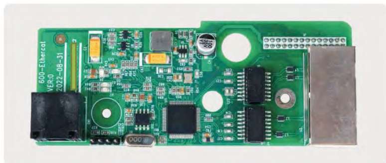
Рисунок 2-5 Внешний вид коммуникационной карты Ethercat
