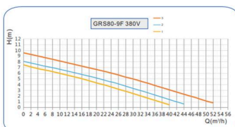
Рисунок 14 – Технические характеристики для серии 80-9F-380V
