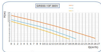
Рисунок 11 – Технические характеристики для серии 50-13F-380V
