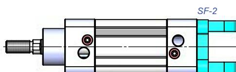
SFWCFM Монтаж при помощи фланца с осью и опорной стойки
