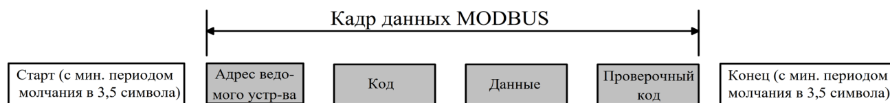
А-рисунок 1-2 Формат сообщений Modbus RTU
