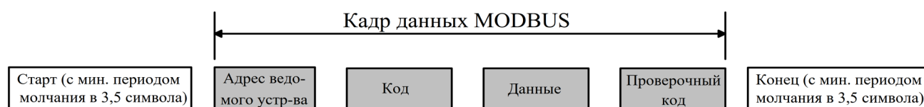
А-рисунок 1-2 Формат сообщений Modbus RTU
